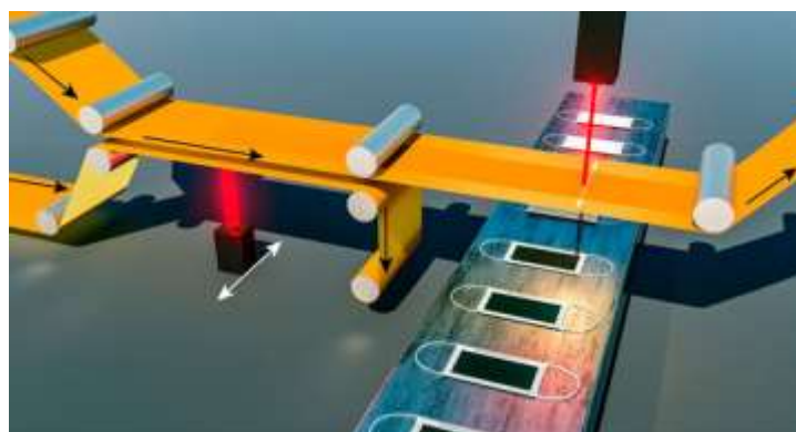
Рис. 3. Иллюстрация непрерывного производства «графеновых» масок методом LIFT при использовании лазерного ИК-излучения в двух режимах.
